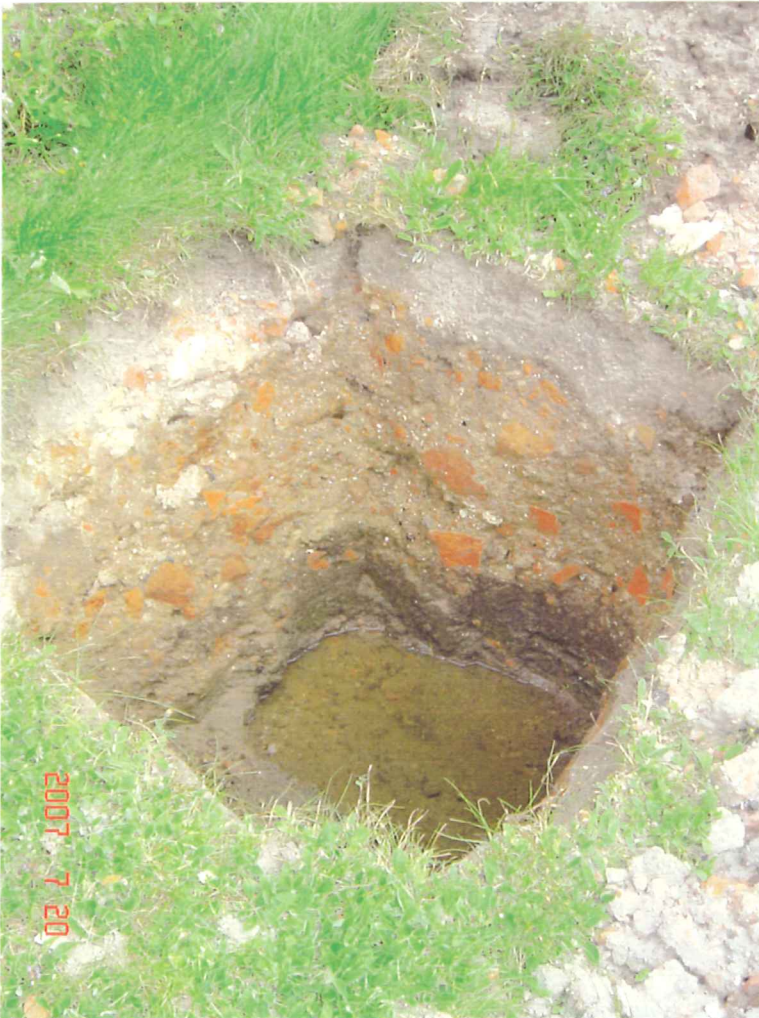
fot.32. Wykop głębokości 100 cm wykonany przez Inwestora, w pobliżu muru zachodniego. W wykopie widoczna warstwa gruzu ceglanego sięgająca 75 cm poniżej poziomu terenu, niżej ił czarny z gliną. Woda gruntowa w wykopie stabilizuje się na głębokości 95 cm poniżej poziomu terenu.
